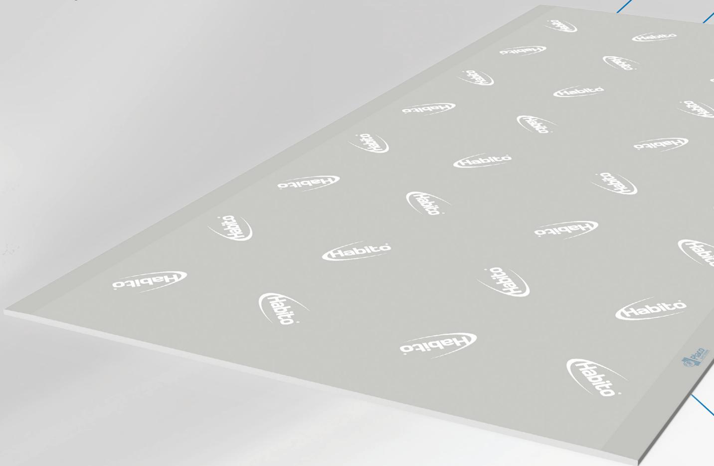
La placa **Habito®** posee un núcleo de yeso aditivado de alta densidad con fibras de vidrio y papel celulósico de alto gramaje que le otorgan solidez, aislamiento térmico, acústico, resistencia al impacto, al fuego y la mayor resistencia mecánica conocida hasta el momento en placas de yeso laminado.
