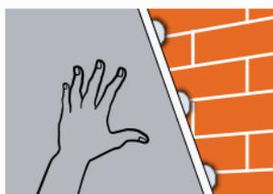
Una vez colocada la placa sobre el muro, será llevada a su nivel con una regla, la pega formará una “torta” de una longitud no inferior a los 15 cm y 2 cm de espesor. De esta forma las pepas perimetrales formarán una banda en todo el perímetro de la placa evitando el efecto trampolín.
